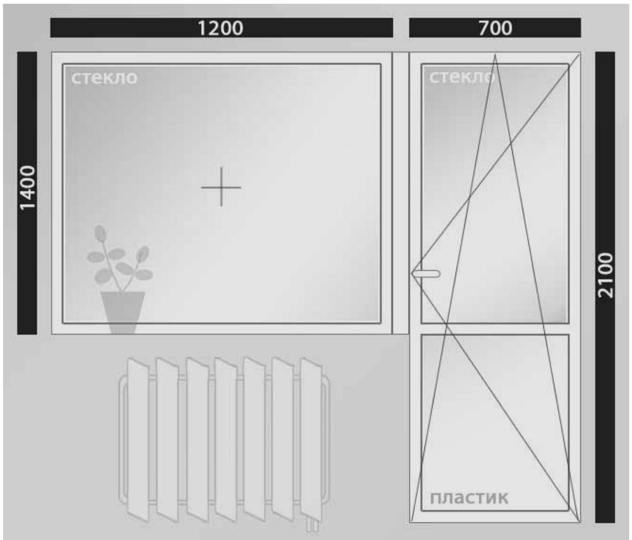
**Рисунок 4 – Пример заполнения (оконный блок и балконная дверь)**
