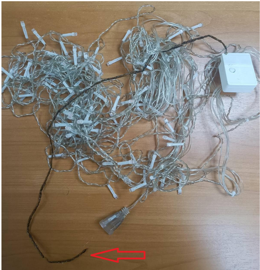
Гирлянда с поврежденным питающим проводом и отсутствующей вилкой для подключения в электрическую сеть.
