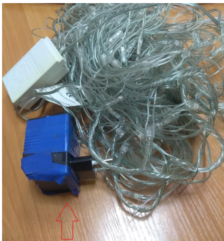
Гирлянда с поврежденным корпусом блока питания.
