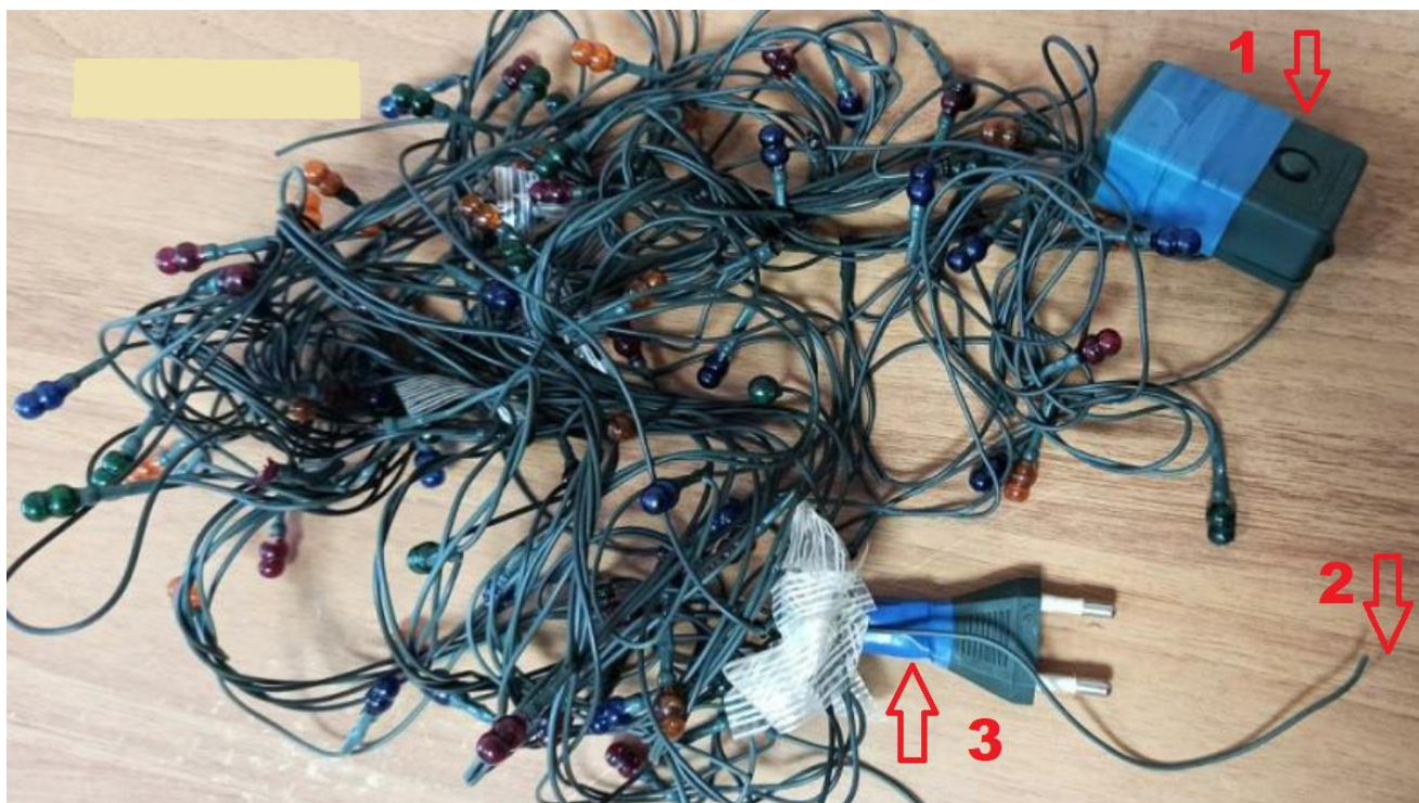
Гирлянда с характерными неисправностями: 1 - поврежден корпус контроллера; 2 - повреждена целостность провода; 3 - поврежден провод в месте подключения вилки.
