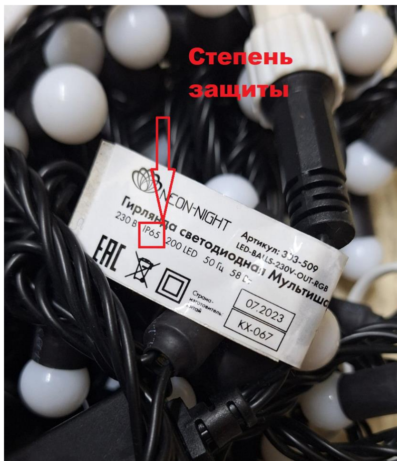
Светодиодная гирлянда со степенью защиты IP 65 (изделие пригодно для использования в помещении и на улице).
