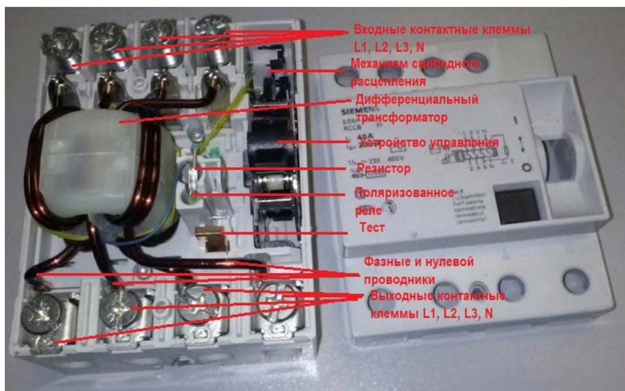
Входные контактные клеммы L1, L2, L3, N
